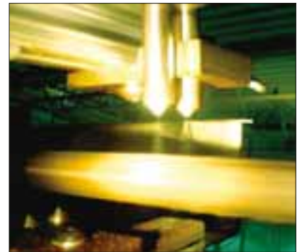
Schmierung einer "high speed" Kette
