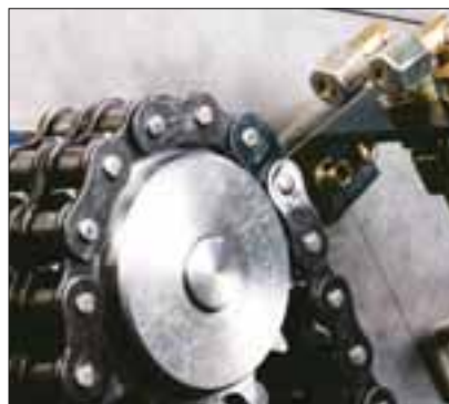
Berührungsloser Ölauftrag mittels Düsen
