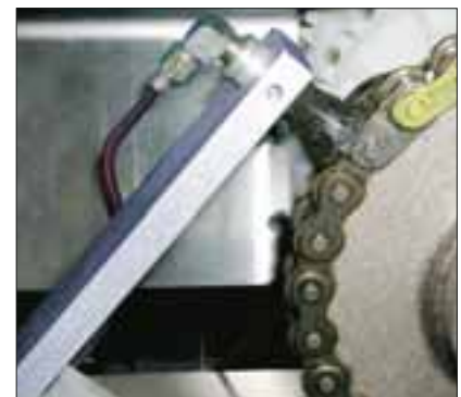
Konventioneller Ölauftrag mittels Pinsel
