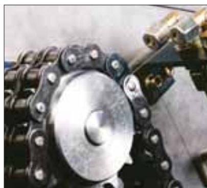
Berührungsloser Ölauftrag mittels Düsen
